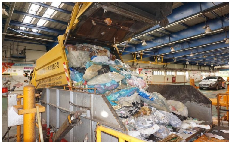
將垃圾車駛入廠區內倒出垃圾
